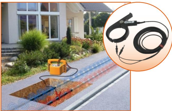
Mit der speziell auf das Easyloc abgestimmten Sendezange Easyclamp besenden Sie Kabel, ohne diese vom Netz zu nehmen. Die Sendezange wird um das zu besendende Kabel gelegt und an den Easyloc Tx Sender angeschlossen.
