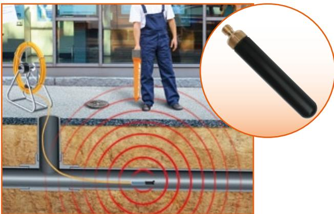
Der Molchsender MLS 55-3 ist ein batteriebetriebener Minisender und hat eine Reichweite von 5 m. Er wird – auf einen Schubkabel aufgeschraubt – zur Ortung von Leerrohren oder Verstopfungen eingesetzt.
